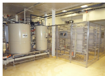
Obrázek 10: Jednotky ED - farmaceutický a potravinářský průmysl - MEGA a.s.
