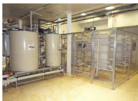
Obrázek 12: Fotografie jednotek elektrodialýzy na demineralizaci syrovátky společnosti MEGA a.s. v Rusku a v České republice
