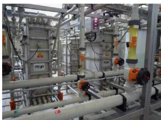
Obrázek 12: Fotografie jednotek elektrodialýzy na demineralizaci syrovátky společnosti MEGA a.s. v Rusku a v České republice
